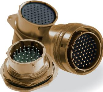
Rundsteckverbinder PT mit Bajonettverriegelung, bis zu 61 polig, für Crimp- oder Einlötkontakte.
