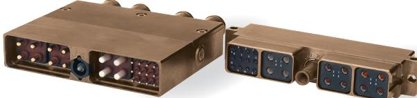
Modularer Rechtecksteckverbinder, max. 120 polig, zur Aufnahme von 4 Inserts gemäß EN 4165. Diese Inserts sind lieferbar mit Kontakten von AWG23 bis AWG8, sowie High-Speed, Fiber Optik oder RJ45 Modulen.
