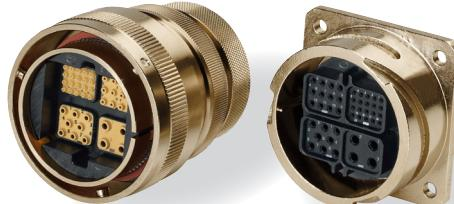
Modular Reverse Bajonett Stecker GCB-M, max. 120 polig, Gehäusegröße 32, zur Aufnahme von 4 Inserts gemäß VG96513 für Kontakte: AWG 23 bis AWG 8, FO-Kontakte (MT, Lumière, ARINC801), RJ45, sowie Koax-, Quadrax-Kontakte.
