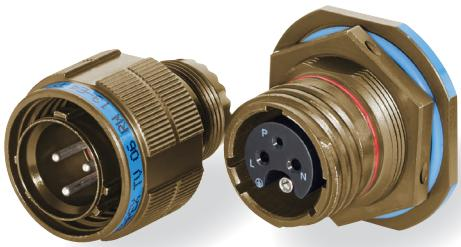
Rundsteckverbinder TV konform mit MIL-DTL-38999 Serie III. Powerstecker von 250V bis 500V mit voreilen-dem Massekontakt gemäß DIN EN 61984.
